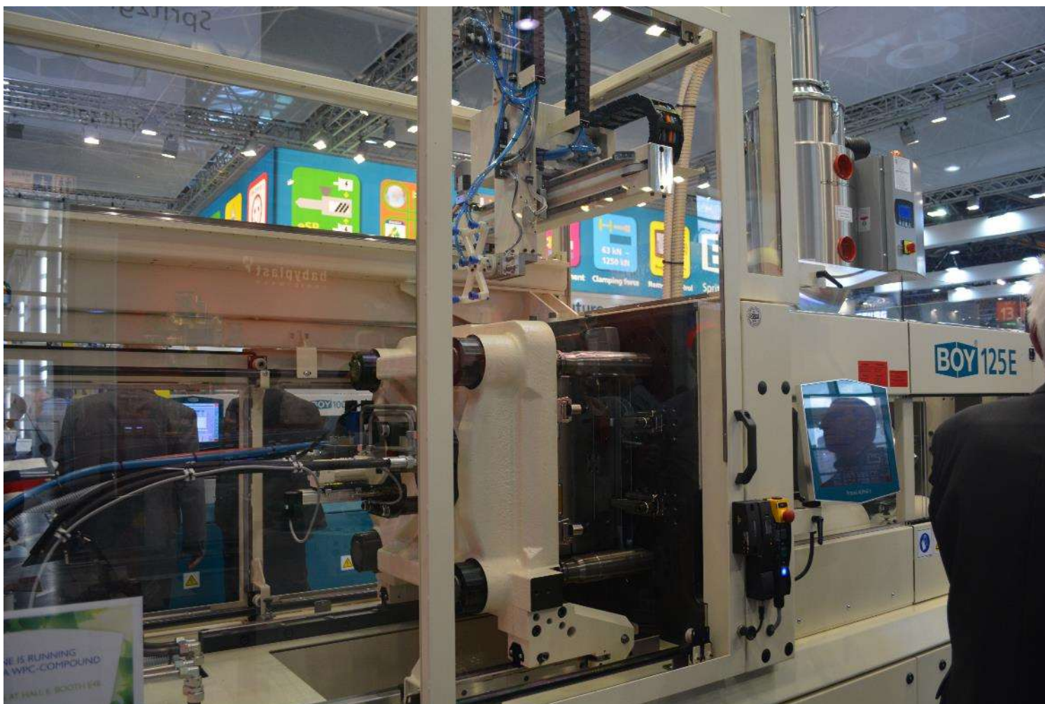
BOYの成形機の特徴は射出側に引っ張る型締機構により省スペース
